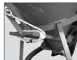
Sistema di apertura bocca di scarico Exhaust opening system
