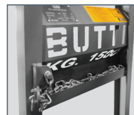
Sistema di chiusura e raccogliatore catena Closing system & chain compartment
