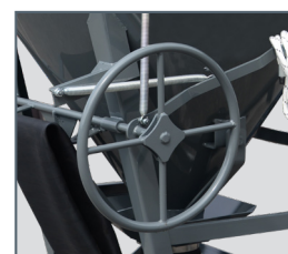
Volantino di apertura e chiusura della bocca di scarico Wheel to open and close the discharge opening
